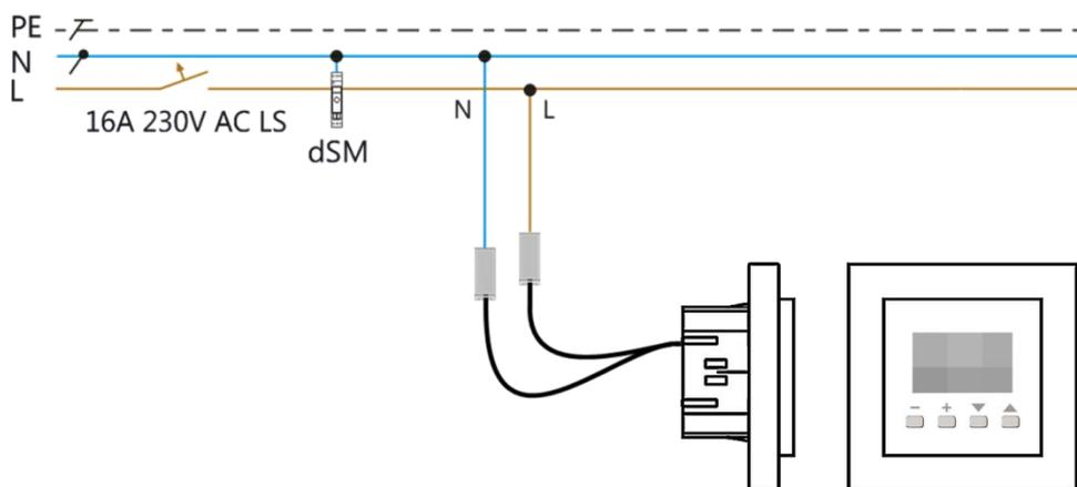
Nach dem elektrischen Anschluss und dem Einschalten der Spannungsversorgung meldet sich das Gerät automatisch am digitalSTROM-Meter im Stromkreisverteiler an. Anschließend ist das Gerät sofort betriebsbereit, beginnt mit der Erfassung der Raumtemperatur und Luftfeuchtigkeit und meldet diese ins digitalSTROM-System.
