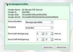
Je nach Anwendung kann die Ausschaltverzögerung unter digitalSTROM / Geräteeigenschaften herab gesetzt werden. Hardware bedingt, ist die interne Ausschaltverzögerung mindestens 12 Sekunden.
